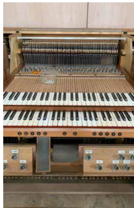
Eine Operation am „offenen Herzen der Orgel“ war die Sanierung des Spieltisches. Seine Mechanik war über die vielen Jahre ausgeschlagen und musste neu ausgeglichen werden, so dass nun jede Taste wieder den gleichen Druckpunkt besitzt.
